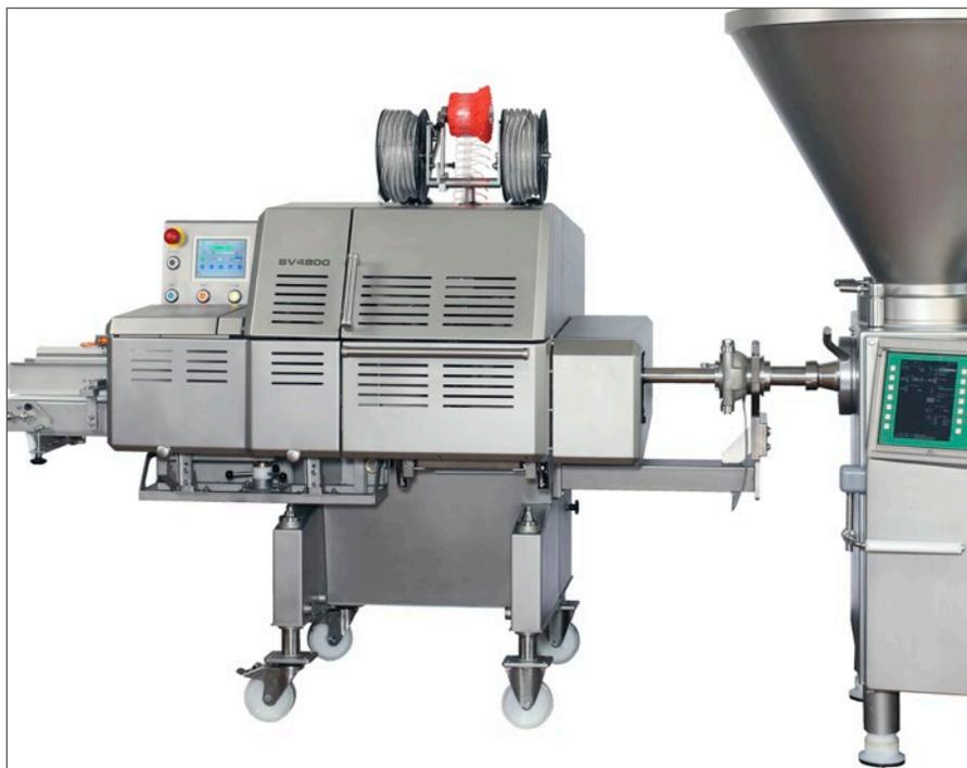
La cinta de salida giratoria garantiza productos con reproducibilidad de calibre, mediante velocidades de la cinta transportadora programables y regulables gradualmente sin escalones. La altura de la cinta de salida se puede adaptar sencilla y rápidamente al producto correspondiente.
