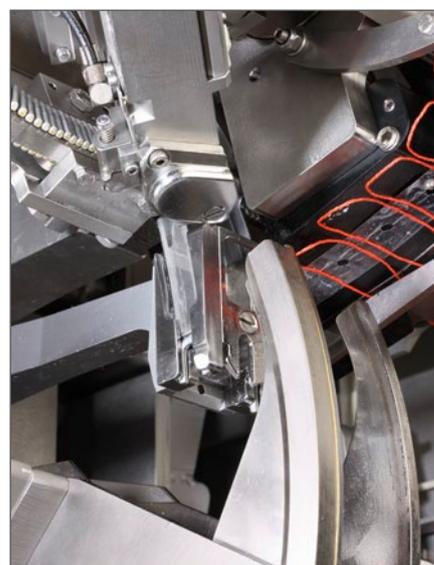
**Técnica de clip “ida y vuelta” tipo Shuttle: división y clipeado – de alta precisión, rápido, con reproducibilidad de calibre y tratamiento cuidadoso de la tripa.**
