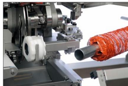
**Mecanismo “Quick-Release” para un cambio rápido de la tripa**
